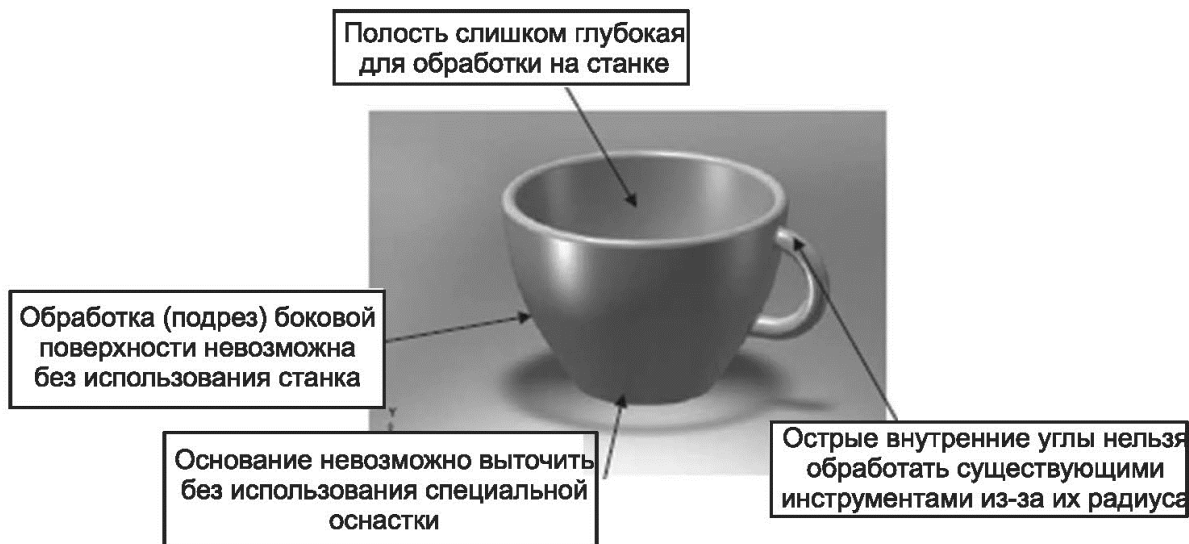
Рисунок 3.1 – Поверхности, обработка которых представляет проблему для станков с ЧПУ
