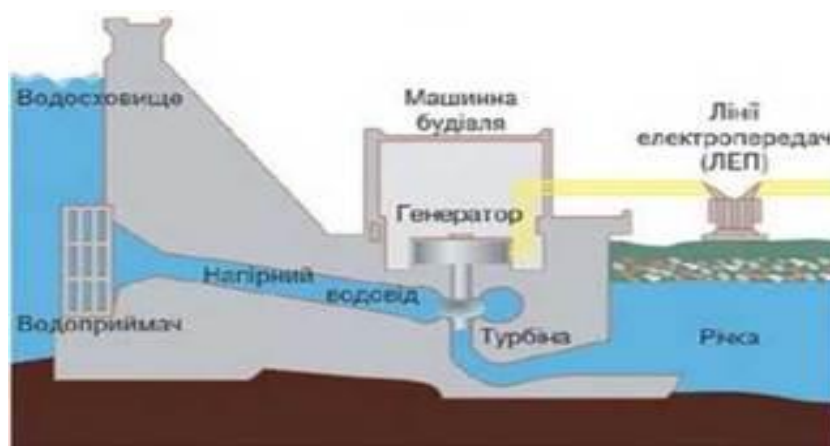
Мал.1 Схема греблі на сучасних гідроелектростанціях
