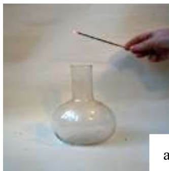
Виявлення кисню: а - жевріюча скіпка на повітрі; б - спалахування скіпки в кисні
