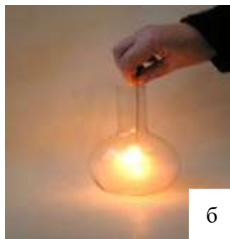
Виявлення кисню: а - жевріюча скіпка на повітрі; б - спалахування скіпки в кисні
